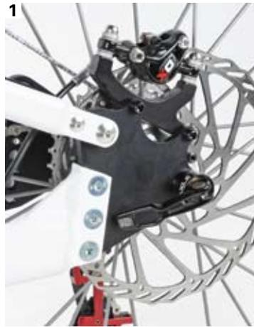
**1\_Kommt fett:** Das massive Ausfallende nimmt Steckachse, Bremse, Dämpfer-Druckstrebe auf und wird durch drei starke Schrauben an der Kettenstrebe befestigt. Das schafft Vertrauen!
