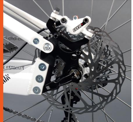
**GUTES ENDE** Das Ausfallende ist ebenfalls eine saubere Fräsarbeit, verschraubt mit der massiven Kettenstrebene, Hinterachse 12 mm Rear Maxle.
