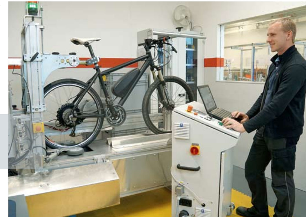
GO SwissDrive Testlabor in Gams: Auf diesem Prüfstand lassen sich realitätsnahe Bedingungen simulieren, sogar Schrägfahrten. Auch Motoren der Mitbewerber müssen ihre Leistungsdaten beweisen.
