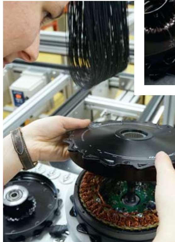
Oben rechts: Platinen des GO SwissDike Antriebs. Links: Mit UV-Licht wird der Drehmomentsensor in der Platine fixiert. Bild in der Mitte: Deckel drauf und verschrauben. Für beste Robustheit ist der Schweizer Heckantrieb absolut staub- und wasserdicht. Links unten: Großkunden können die Software, Motorendeckel und Aufschriften nach Wunsch konfigurieren. Unten: Aufspielen der Software und abschließender „End of the Line“-Test.
